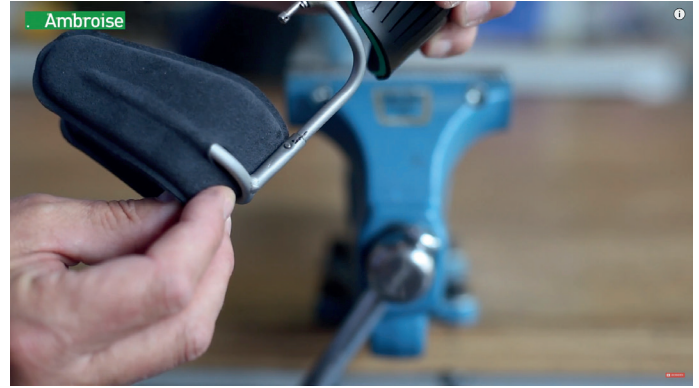
Stap 6: De lasdruppel is nu in de buis gedrukt en houdt de handondersteuning op zijn plaats.
