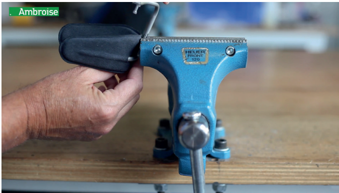
Stap 5: Druk de lasdruppel met behulp van een bankschroef in om de handondersteuning op zijn plaats te houden.
